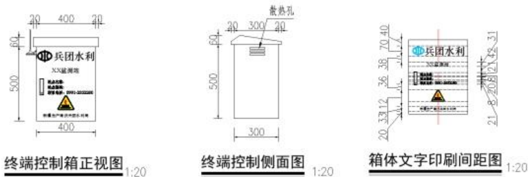
图 3.2- 12 设备箱设计示意图
